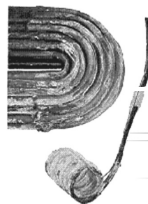
Verkalkung auf Heizschleifen
